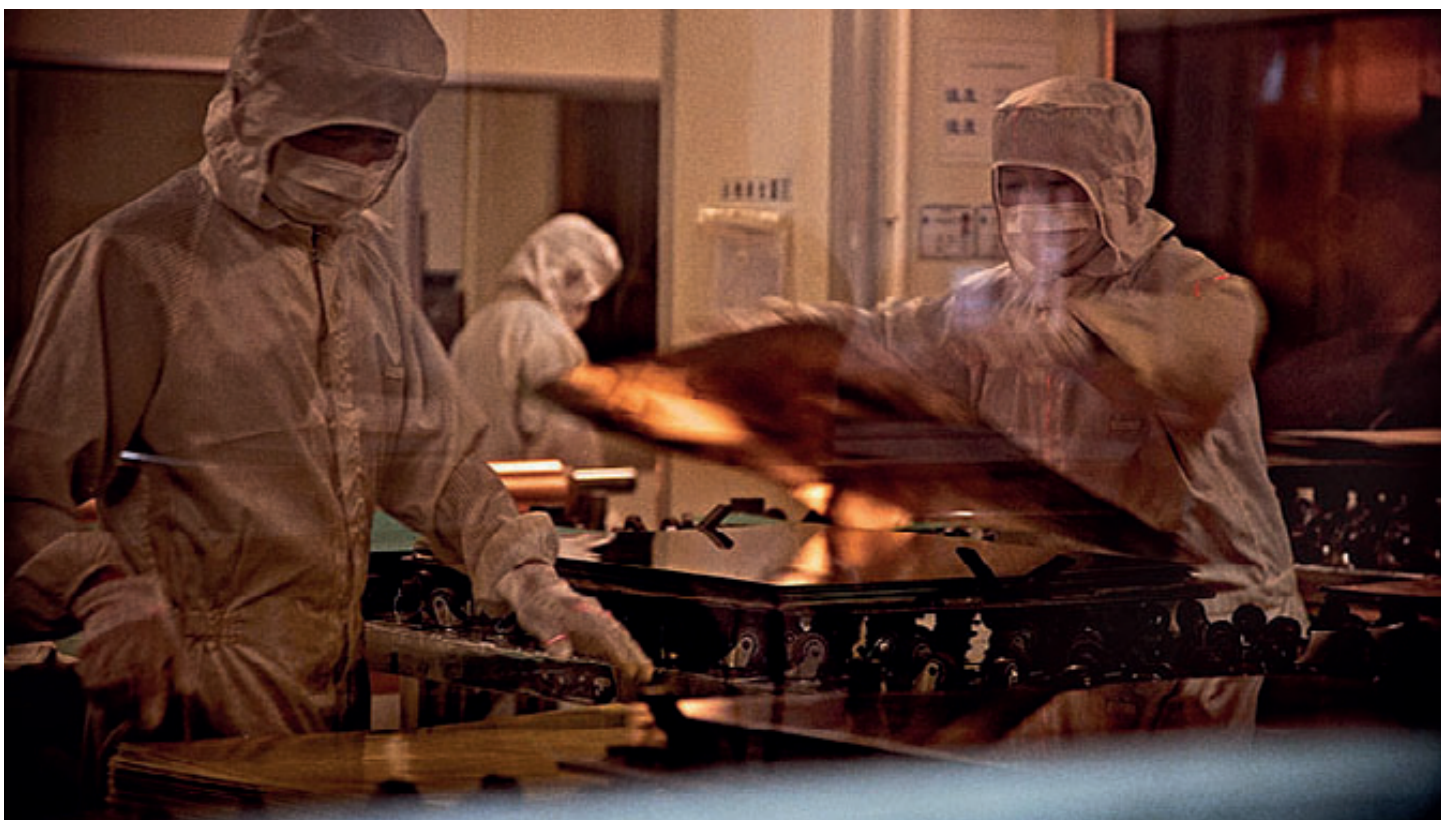
NCAB stiller høje krav til renhed, f.eks. som her ved opbygningen af "multilayer" pcb forud for presningen.
