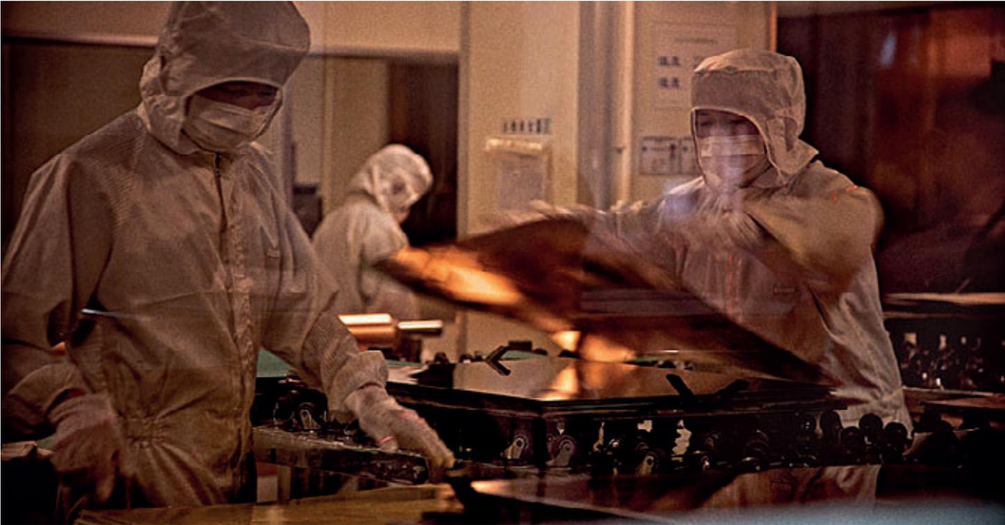
NCAB legt hohe Standards bezüglich des Reinheitsgrads an, wie man hier bei der Produktion von Multilayern vor dem Pressvorgang sehen kann.
