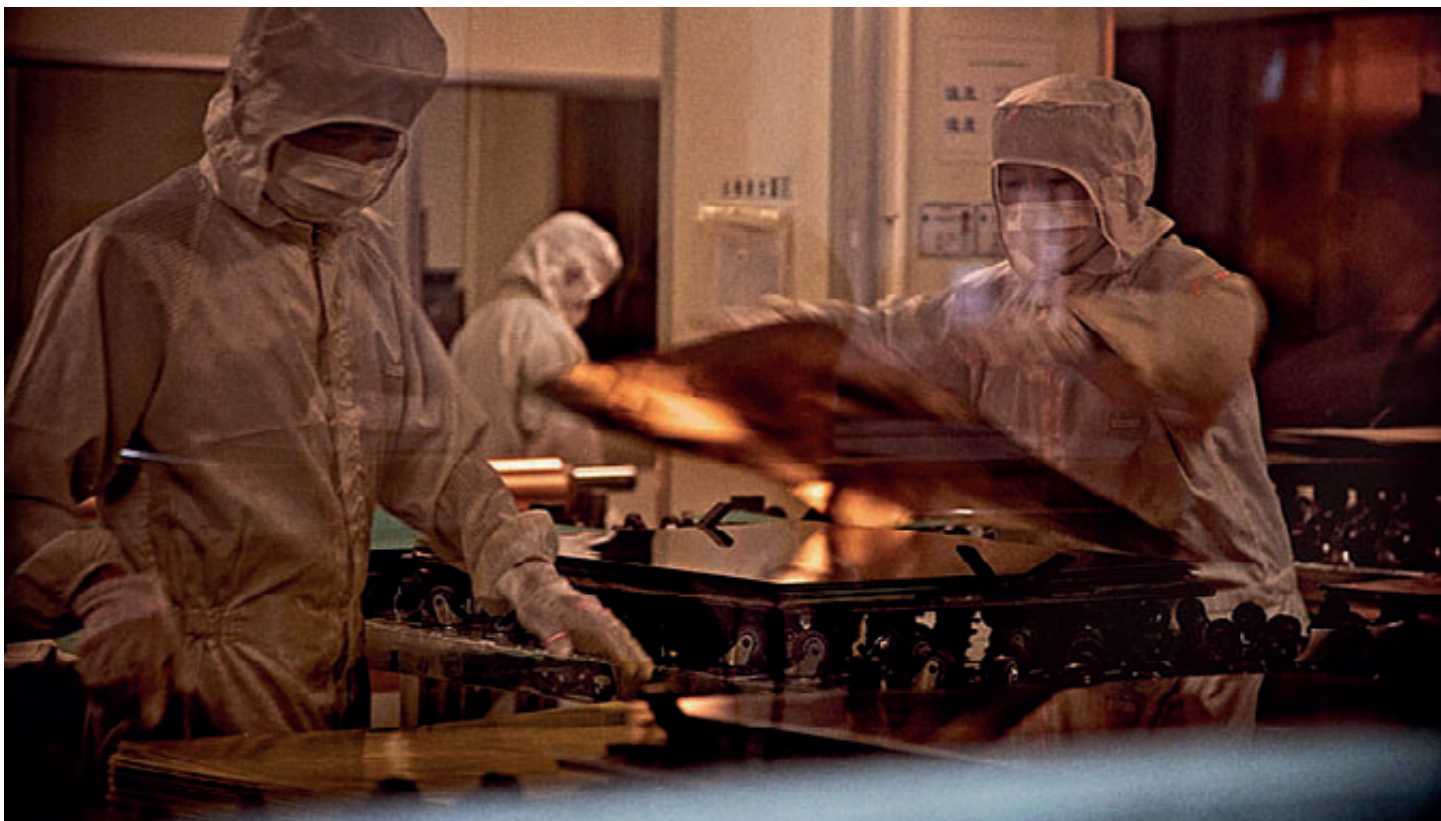
NCAB Group ställer höga krav på renhet som till exempel här vid uppbyggnad av multilayer inför pressning.
