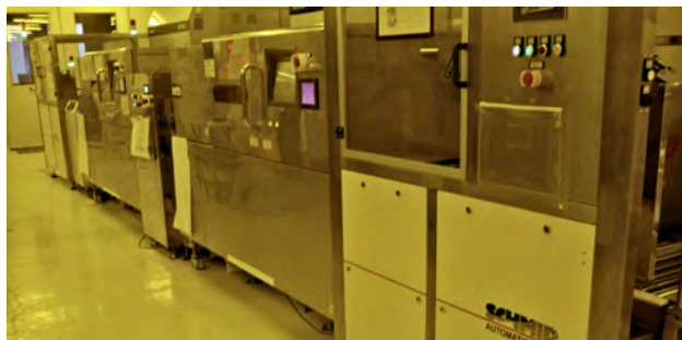
I en LDI-maskin (LDI=Laser Direct Imaging) överförs mönstret med en laserstråle direkt på produktionspanelen.
