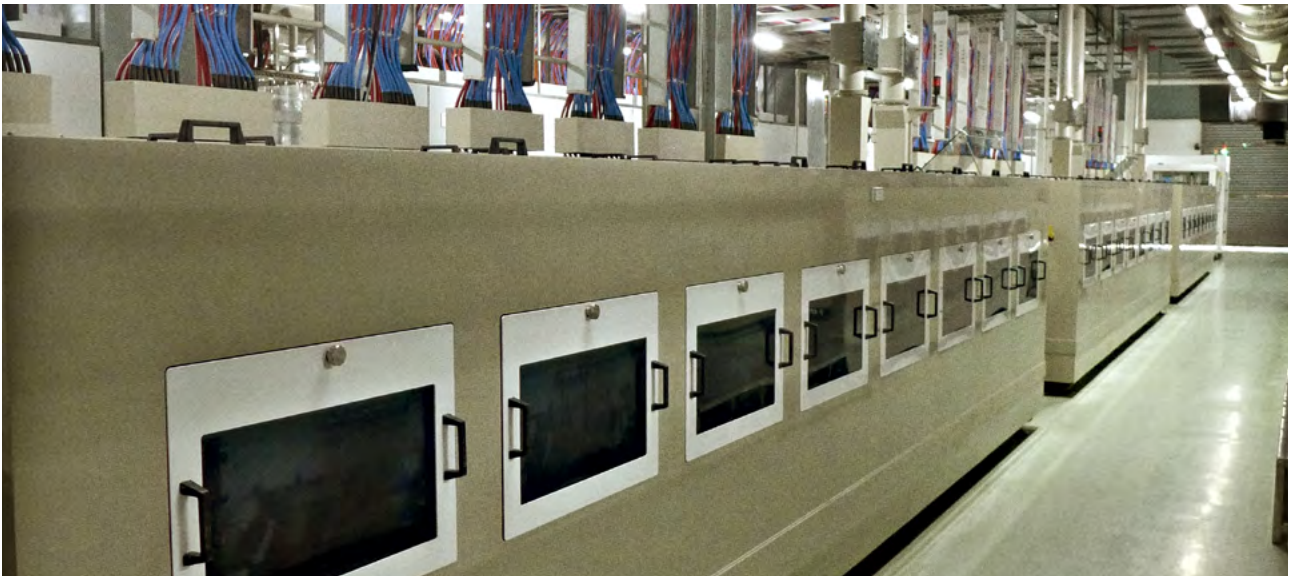
En horisontell pläteringslinje som används för att plätera mikroviar på HDI-kort.
