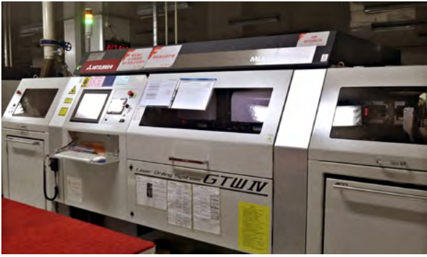
W produkcji płytek HDI wykorzystuje się wiercenie laserowe.
