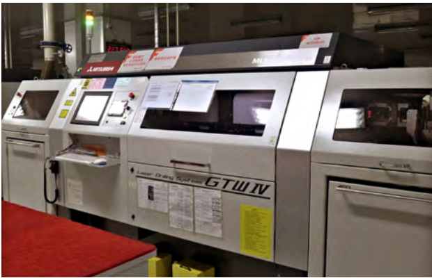
Станок для лазерного сверления, используемый при производстве с применением техники HDI.
