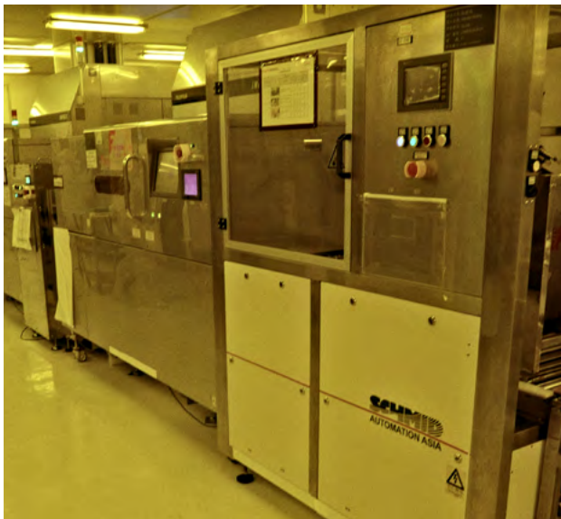
Установка прямого лазерного экспонирования (Laser Direct Imaging, LDI) переносит и печатает шаблоны непосредственно на материале печатной платы при помощи лазерных лучей.
