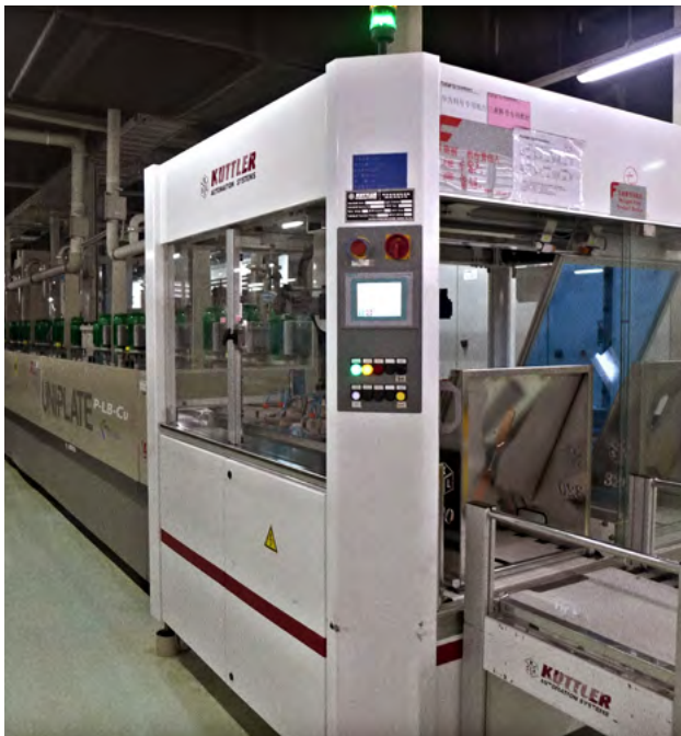
Горизонтальный конвейер очистки отверстий платы от остатков смолы и для металлизации переходных отверстий.
