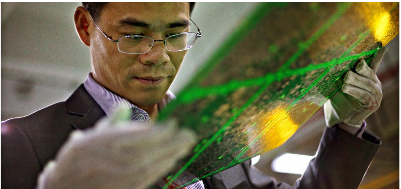
La panelización es un factor importante y debería incluirse en las especificaciones que se envíen a los proveedores potenciales. En la foto, Dana Chen, NCAB Group China.
