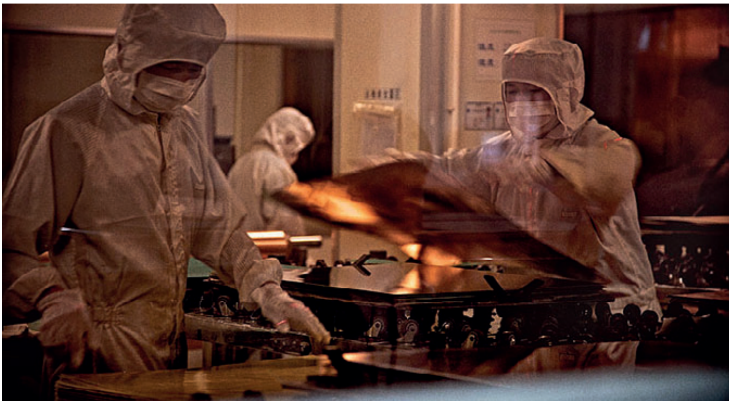
NCAB Group asettaa tiukat puhtausvaatimukset, kuten tässä prässäystä edeltävässä piirilevykerrosten valmistuksessa.
