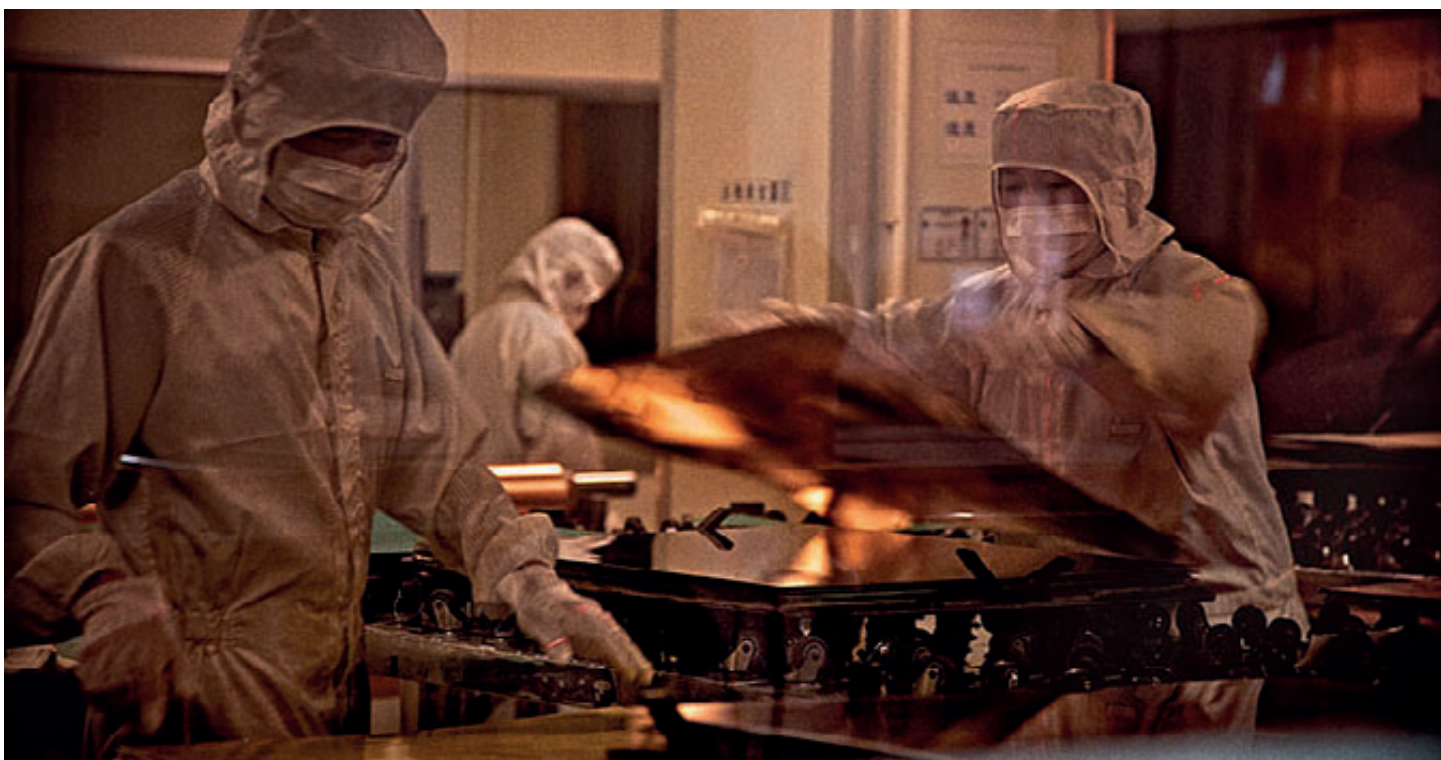
NCAB impose des normes élevées en matière de propreté, ici dans la fabrication de multicouches avant le pressage.
