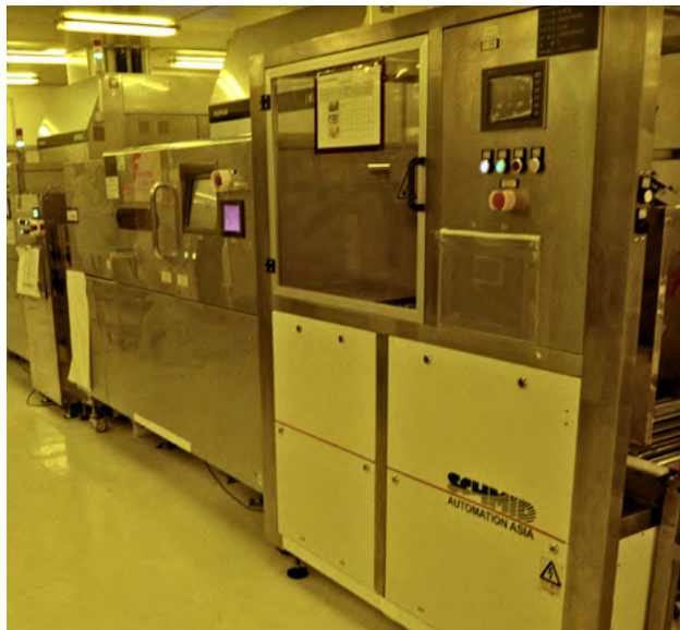
En direkte laser-mønsteroverføringsmaskine (LDI) overfører (og trykker) mønsteret direkte på printkortmaterialet ved hjælp af laserstråler.
