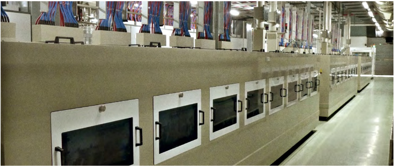
Vandret pletteringslinje til kobberfyldning af mikroviaer på HDI-produkter.
