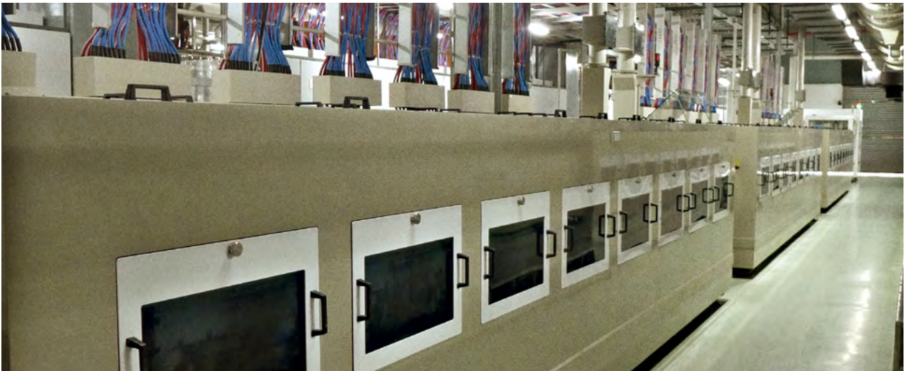
Une chaîne de métallisation horizontale utilisée pour le remplissage de cuivre de microvias sur un produit HDI
