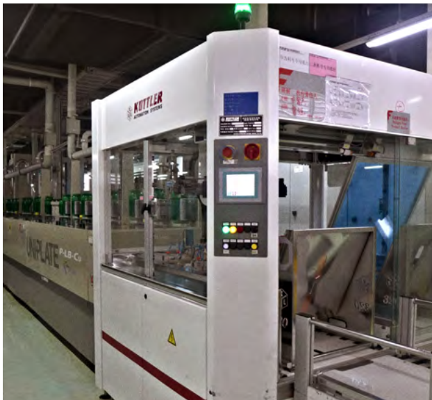
Ligne de desmearing horizontal et chaîne PTH.
