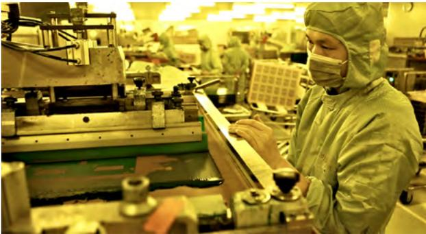
深圳崇达公司清洁室内的压层台。UL在互联网上建立了一个免费数据库，用户可以搜索获得认证的PCB、板材和表面处理。
