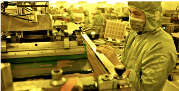
Lamineringsstation i renrummet på Suntak, Shajing. UL har en åben database på internettet, hvor man kan søge blandt godkendte printkort, laminater og overflademateriale.
