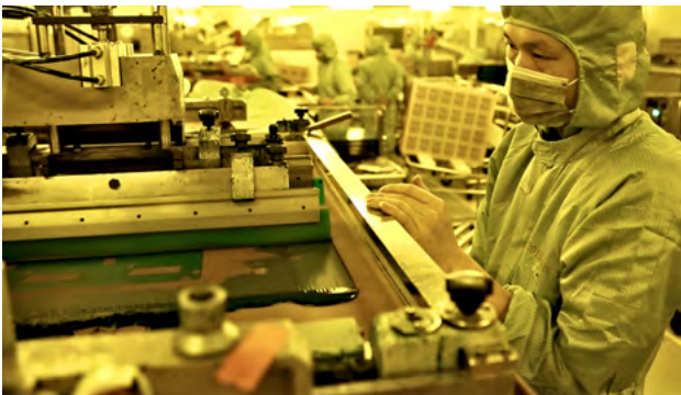
Screentryck i renrum på Suntak, Shajing. UL har en öppen databas på internet där man kan söka bland godkända mönsterkort, laminat och ytbehandlingsmaterial.
