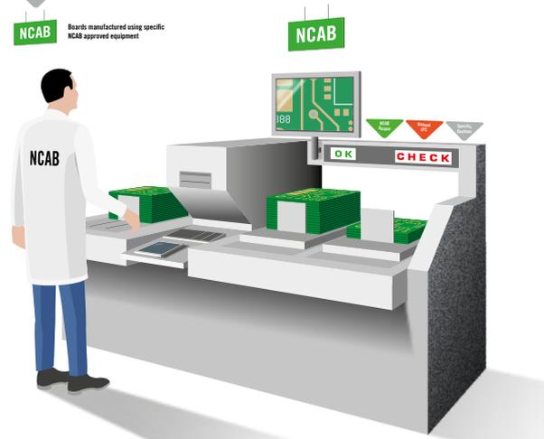
“L'ispezione finale” è la penultima fase del processo di produzione, durante la quale il PCB viene sottoposto ad esame visivo da addetti al controllo qualità approvati da NCAB, utilizzando il nostro capitolato di requisiti standard. La scheda elettronica viene confrontata con il file Gerber utilizzando AVI, che è più veloce dell'occhio umano, il processo è comunque monitorato dai nostri addetti al controllo.
