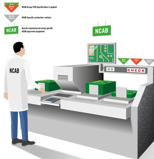
Die Endkontrolle ist der vorletzte Schritt des Produktionsprozesses. Hierbei werden die Leiterplatten einer Sichtkontrolle durch von NCAB zugelassene Qualitätsprüfer unterzogen, welche die Leiterplatten gemäß den Anforderungen unserer Standard-spezifikation überprüfen. Die Leiterplatte wird mittels AVI, das schneller als das menschliche Auge arbeitet, mit den Gerberdaten verglichen, wobei der Vorgang durch unsere Prüfer überwacht wird.
